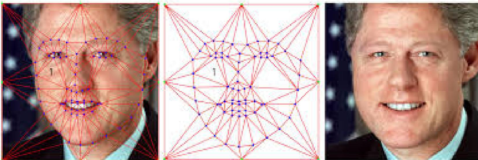
A região destino da transformação pode não ser retangular e não estar alinhada com os eixos. É interessante decompô-la em uma união de trapézios alinhados com um dos eixos para percorrer os pixels da região.
