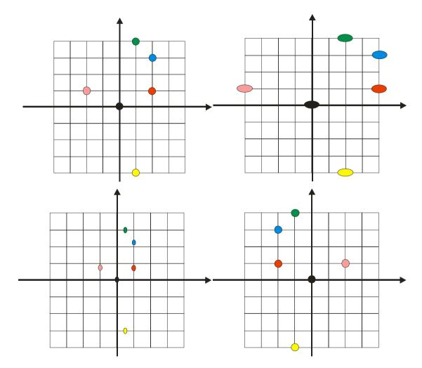
$$\begin{bmatrix} x_1 \\ y_1 \end{bmatrix} = \begin{bmatrix} 1 & b \\ 0 & 1 \end{bmatrix} \begin{bmatrix} x_0 \\ y_0 \end{bmatrix} = \begin{bmatrix} x_0 + by_0 \\ y_0 \end{bmatrix}$$
